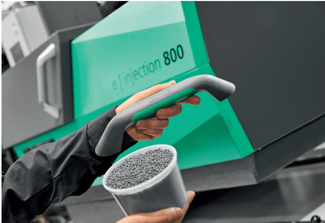
Bild 1. In einer Kombination aus Mehrkomponenten- und Schaum-Spritzgießen werden Industriegriffe ressourceneffizient aus PCR-Material und TPE in Hart-Weich-Verbindung gefertigt (© Arburg)
